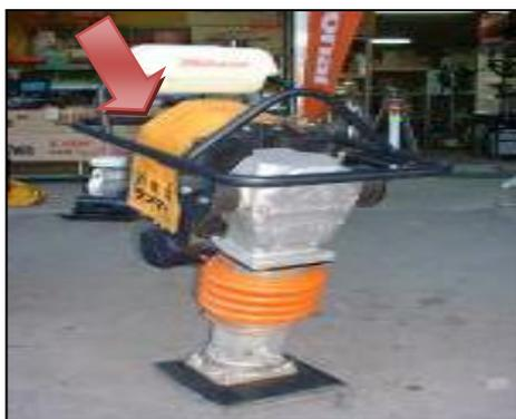
圖 7 機具部分設備加裝隔音罩
