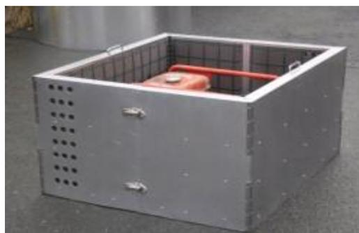
圖 6 機具部分設備加裝隔音罩
